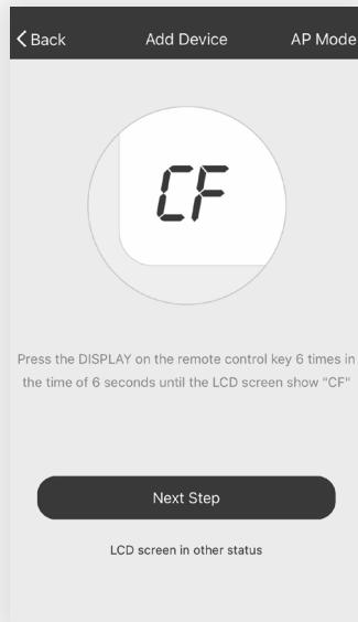
**Remarque :** Si le climatiseur n'est pas en mode CF, appuyez 6 fois sur le bouton Écran (Display) de la télécommande. Après 8 à 10 secondes, vous entendrez deux bips et l'écran du climatiseur affichera CF.
