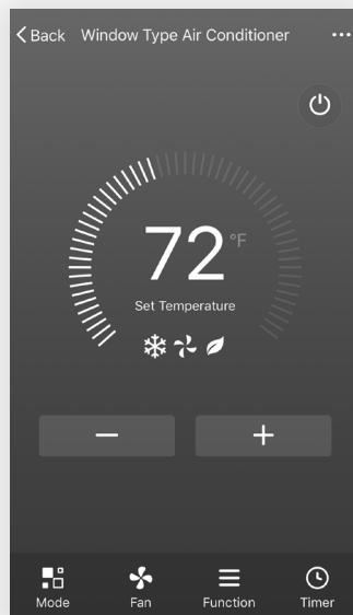
2. Vous pouvez régler les paramètres du mode de fonctionnement que vous souhaitez utiliser : Refroidissement, Chauffage, Sec, Ventilateur, Auto. Cliquez sur le bouton « Mode » et choisissez le réglage que vous souhaitez changer. Remarque : Certains appareils ont également une fonction de chauffage. Le mode Chaleur de l'application ne fonctionnera pas et ne modifiera pas les réglages des climatiseurs qui refroidissent uniquement.
