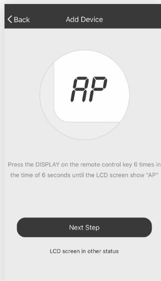
3. Pour commuter le climatiseur sur le mode AP, appuyez 6 fois sur « Display » sur la télécommande en moins de 6 secondes pour que le climatiseur passe du « mode CF » au « mode AP ». Laissez de 10 à 15 secondes à l'appareil pour effectuer la transition et AP clignotera sur l'écran d'affichage du climatiseur une fois l'opération terminée.
