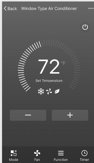
2. Puede ajustar la configuración del modo de funcionamiento que desee utilizar: COOL, WARM, DRY, FAN, AUTO. Haga clic en el botón MODO y elija el modo que desee cambiar.
