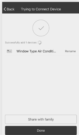
**Remarque :** Si vous devez à tout moment recommencer, appuyez 6 fois sur « Display » (affichage) sur la télécommande pour réinitialiser la configuration sans fil du climatiseur et revenir au mode CF. Appuyer encore 6 fois sur le bouton « Display » (affichage) après l'apparition du mode CF fait passer l'appareil en mode AP. Si vous passez du mode CF au mode AP, veuillez laisser à l'appareil 10 à 15 secondes pour effectuer cette transition.
