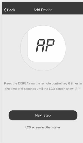
3. Para cambiar la unidad de A/C al modo AP - Pulse DISDPLAY en el control remoto 6 veces en un plazo de 6 segundos para que la unidad de A/C cambie de CF MODE a AP MODE. Espere 10-15 segundos para que la unidad cambie de modo y el AP parpadeará en la pantalla de la unidad de A/C cuando se complete este proceso.
