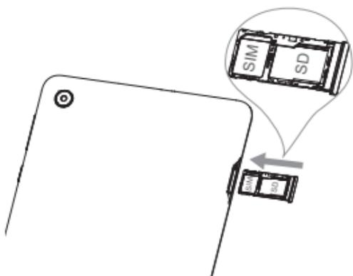
Coloque o extraiga la tarjeta SIM nano y la microSD™ en la ranura correcta tal como se indica.
