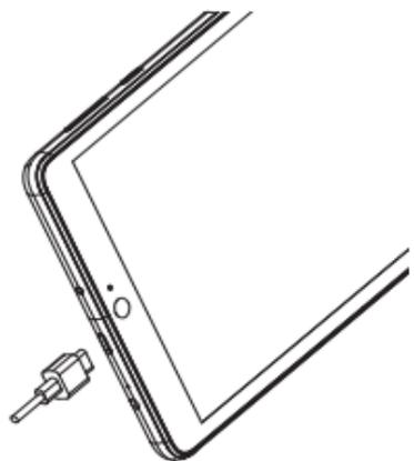
1. Inserte el cable USB tipo C en el puerto de carga, como se muestra.
