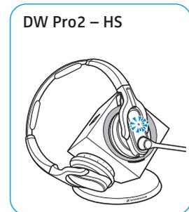
Bei dem ersten Ladevorgang kann es bis zu 5 Minuten dauern, bis die LED Headset blau leuchtet.
