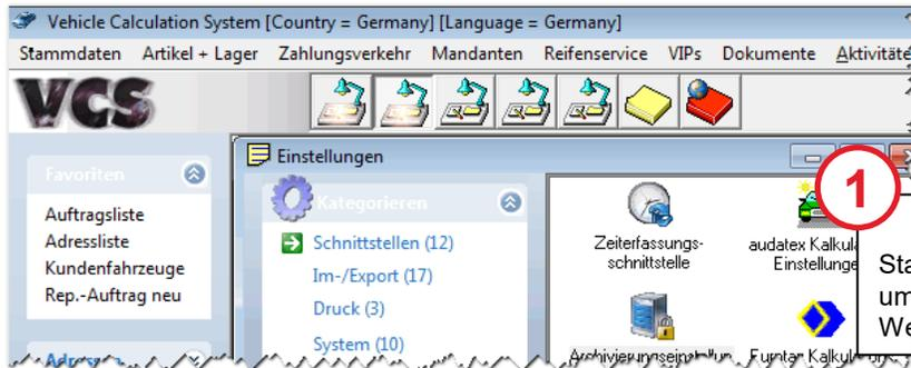
Wählen Sie Stammdaten | Einstellungen | Schnittstellen | Zeiterfassungsschnittstelle, um "Einstellungen Zeiterfassungsschnittstelle" zu öffnen. Wechseln Sie in das Register "Transformationsmatrix für Zeiterfassung".
